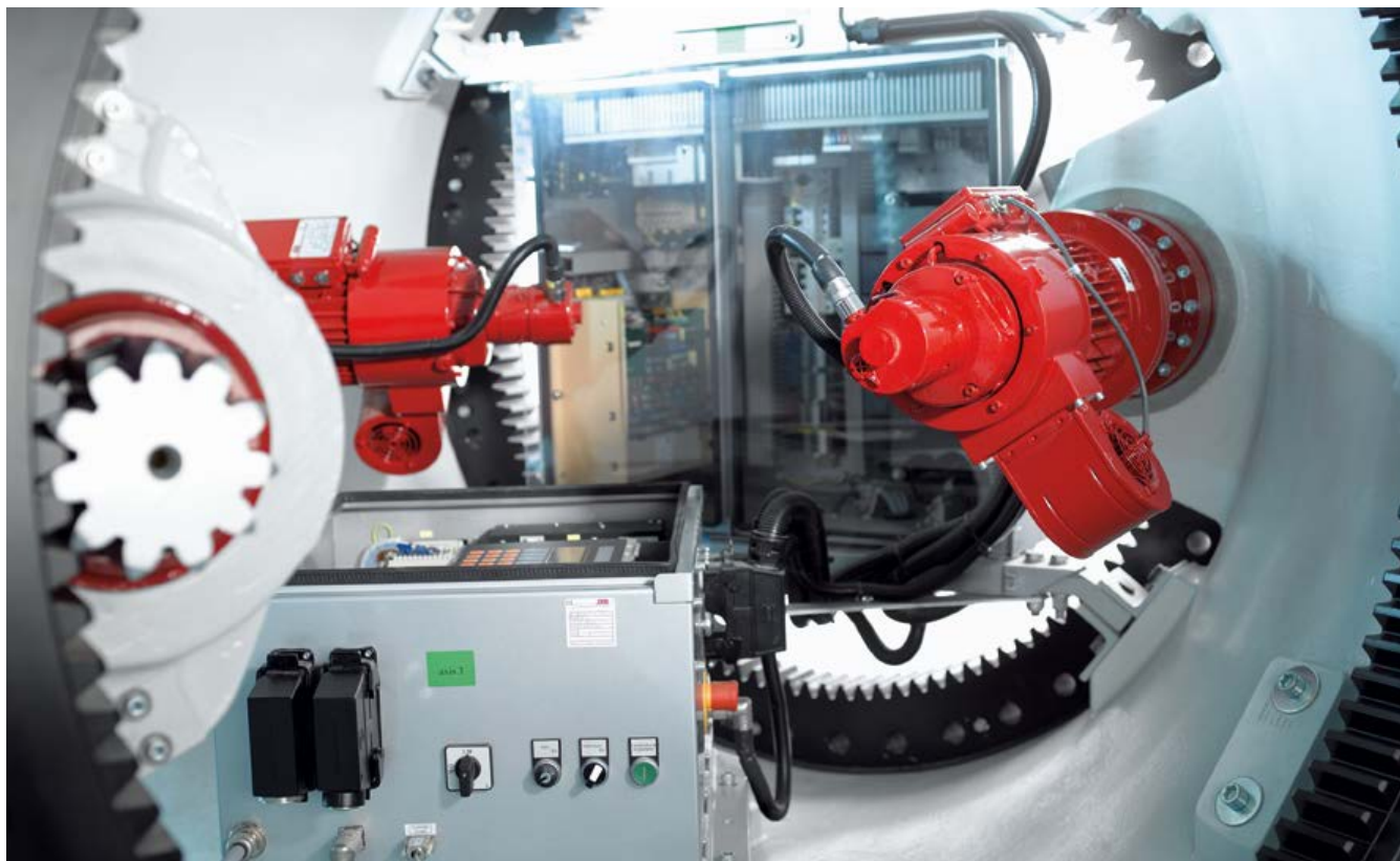
mayr®-тормоз для ветроэнергетической установки в приводе угла поворота лопастей винта
